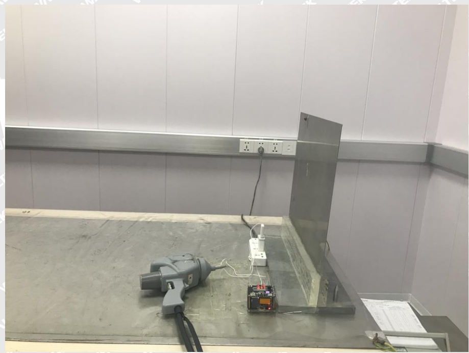
EN 61000-4-2 Test View
