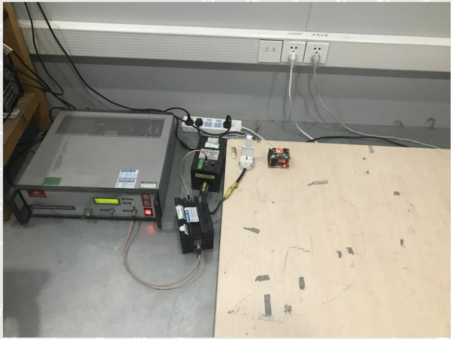
EN 61000-4-6 Test View
