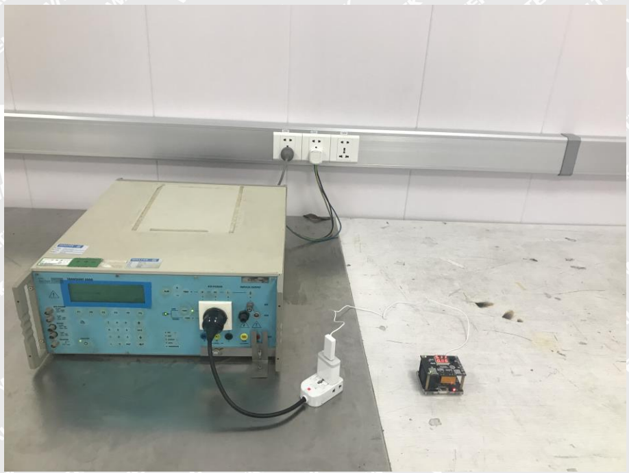
EN 61000-4-4/5/11 Test View
